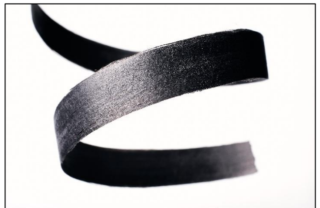
Abb.: Tape aus recycelten Carbonfasern Foto: Philipp Huber
